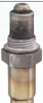
Schutzrohr stark verrußt
